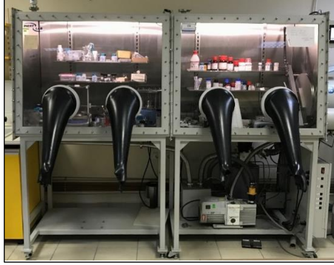
Şekil 6.5: GTÜ Nanoteknoloji batarya laboratuvarı “glove-box”.
