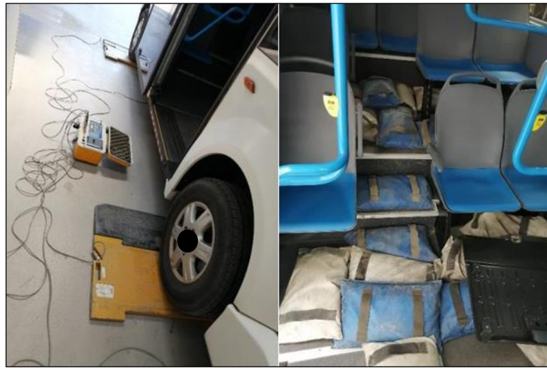
Şekil 3.8: Test aracı yükleme görüntüsü.
