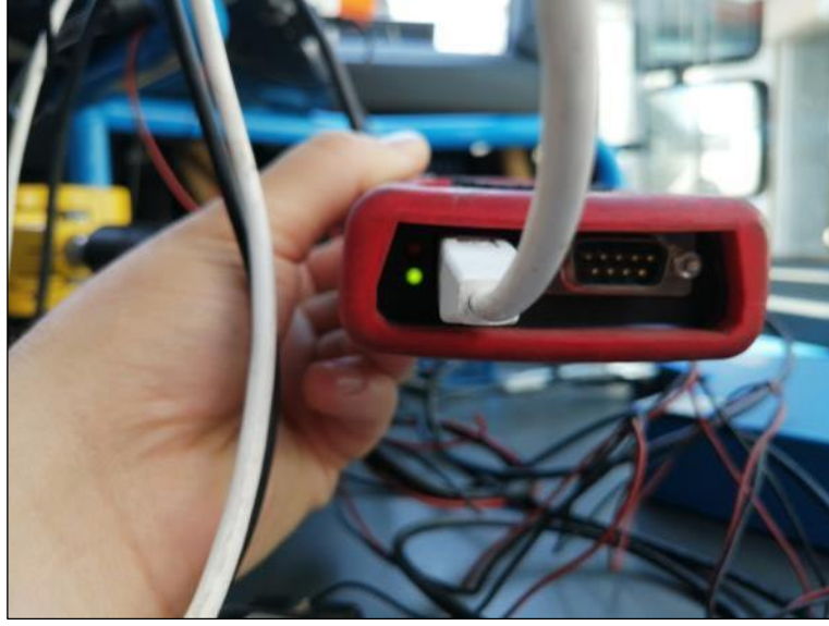
Şekil 3.11: CAN haberleşme sistemi veri kaydedici bağlantısı.
