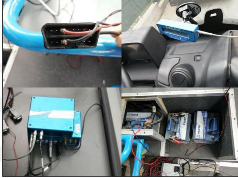
Şekil 3.10: Ölçüm cihazlarının araca bağlantısı.
