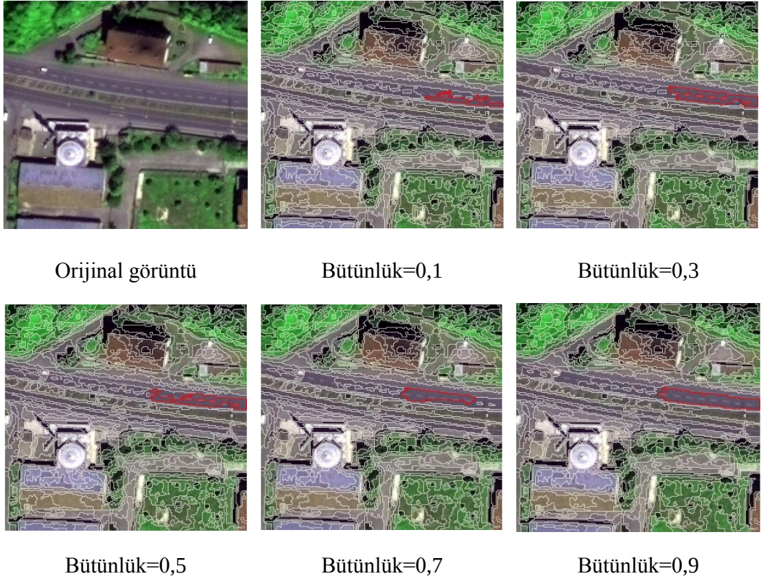
Şekil 4.9. Quickbird uydu görüntüsü üzerinden farklı bütünlük parametrelerinin nesne boyutuna etkisi.
