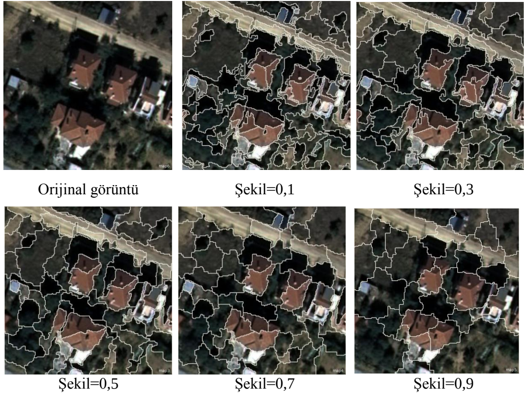
Şekil 4.8. Hava fotoğrafı üzerinde farklı şekil parametrelerinin nesne boyutuna etkisi.
