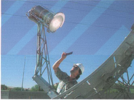
Şekil 3.4. Parabolik Çanak Şeklindeki Solar Yoğunlaştırıcı
