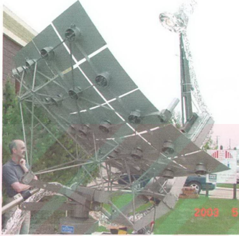
Şekil 3.5. Solar Yoğunlaştırıcı Sistem
