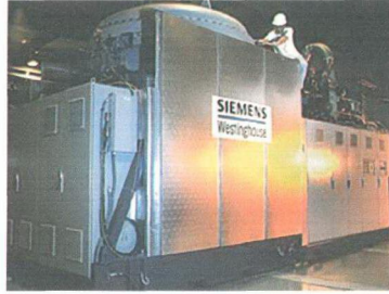
Şekil 7.1 Siemens Yakıt Hücreli Kojenerasyon Sistemi [www.eie.gov.tr, 2005]
