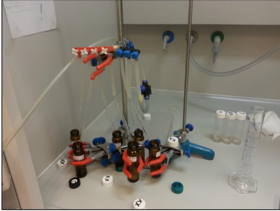
Şekil 3.6: Örneklerin hacimlerinin azot gazı ile 1 ml'ye düşürülmesi.
