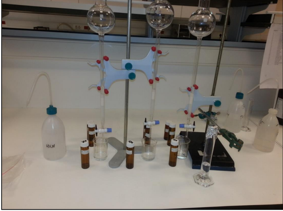
Şekil 3.5: Kolondan geçirilerek temizlenen örnekler.
