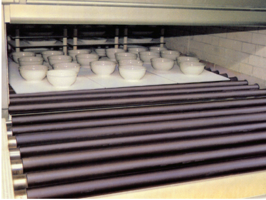
Şekil 1.3. Tünel fırından çıkan porselen ürünler.
