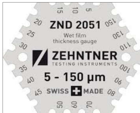
Şekil 4.5: Islak film kalınlığı ölçümünde kullanılmış aparat.
