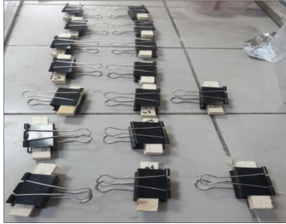
Şekil 3.9: 4 cm 2 alanlarına lateksler sürülerek kısıkaçlar ile birbirlerine tutturulmuş ahşaplar.
