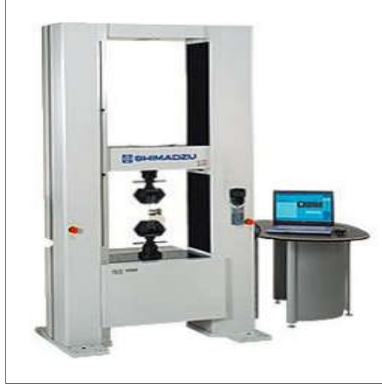
Şekil 2.14: Örnek bir çekme deneyi cihazı.
