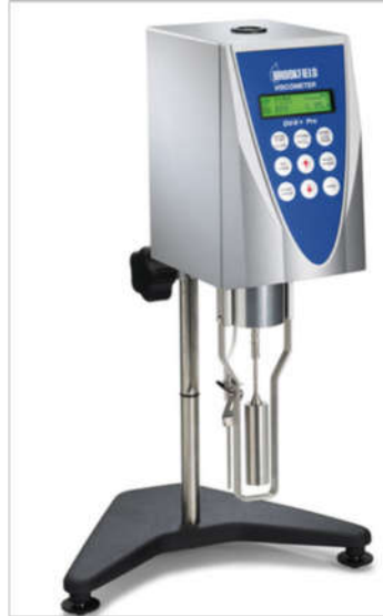
Şekil 3.8: Lateks viskozitelerinin ölçüldüğü Brookfield kinematik viskozimetresi.
