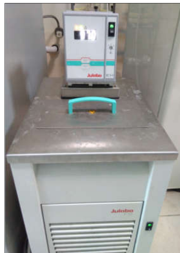
Şekil 3.6: Sentez reaktöründe geri soğutma işlemini yapabilmek için kurulmuş sirkülatör banyosu.
