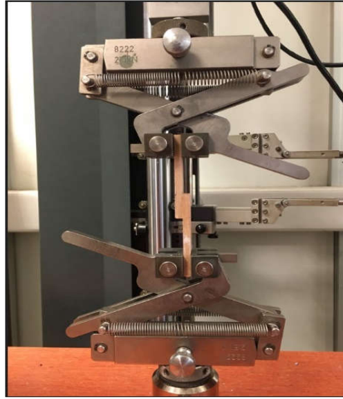
Şekil 3.11: Zwick/Roell çekme deneyi cihazı.
