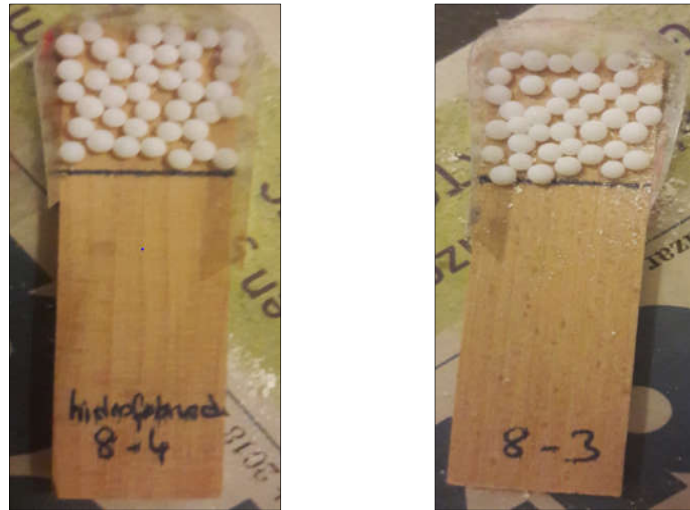
Şekil 3.12: 4 cm 2 alanları 40'ar adet sıvı bilya ile doldurulmuş ahşap örnekleri.
