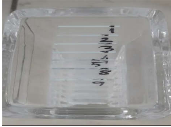
Şekil 4.2: Farklı %BA/%MMA oranlarına sahip cam lam üzerindeki latekslerin, kurutma işlemi için etüve konulmak üzere hazırlanması.
