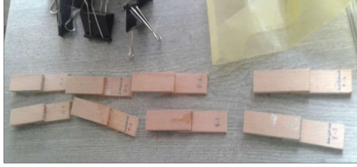
Şekil 3.10: Aralarına 4 cm 2 lateksler sürülerek kısıkaçlar ile birbirlerine yapıştırılmış ve kurutulmuş, ölçümler için bekleyen ahşaplar.
