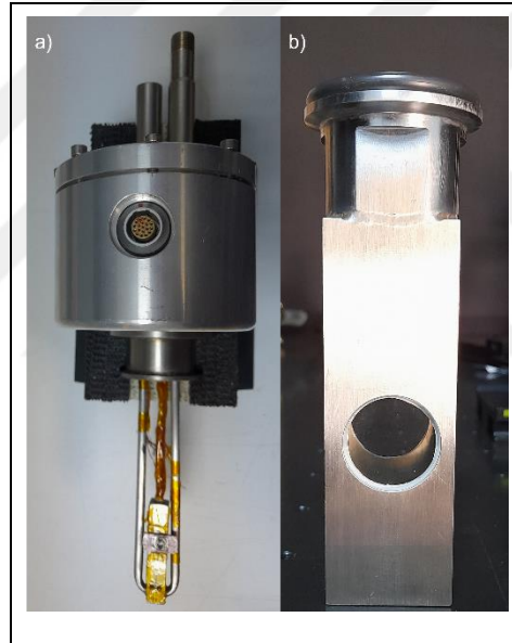
Şekil 3.8: Örnek tutucunun a) üstten fotoğrafı ve b) vakum haznesi.
