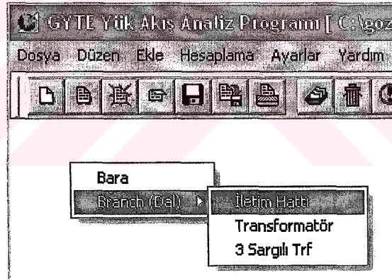
Şekil 5-2 GYTE Yük Akış Analiz Programında Popup Menü ile Nesne Seçimi
