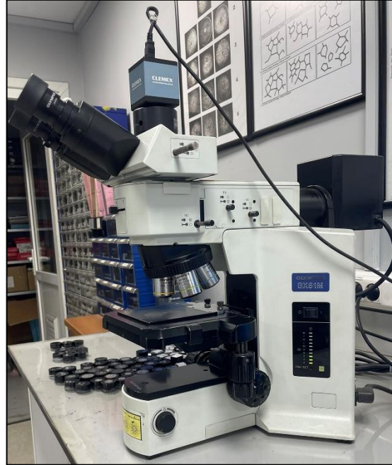
Şekil 5.13: Olympus BX51M ve Clemex kamera.
