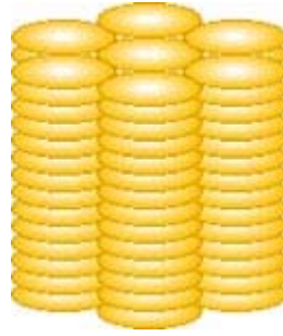
Şekil 2. 12. Sütun biçimli sıvı kristal faz yapısı [internet]
