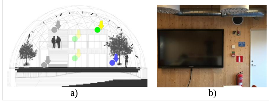
Resim 3.46: a) Yapıda bulunan sensör noktaları, b) Sensörlerin iç mekandaki görünüşleri.
