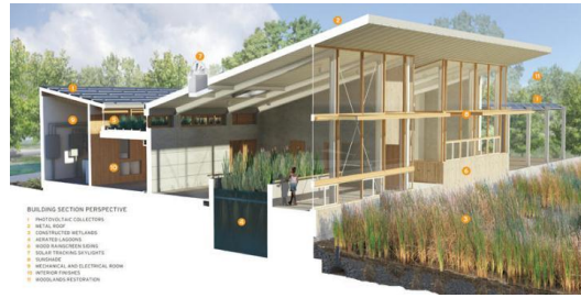
Resim 3.34: Mekanların yerleşimini gösteren kesit görünüşü.
