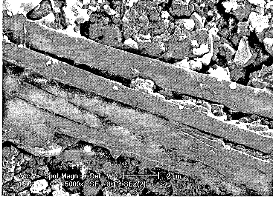
Şekil 4.15. Müllit ve anortit kristallerinin 15000x büyütmede mikroyapı içerisindeki görünümü.
