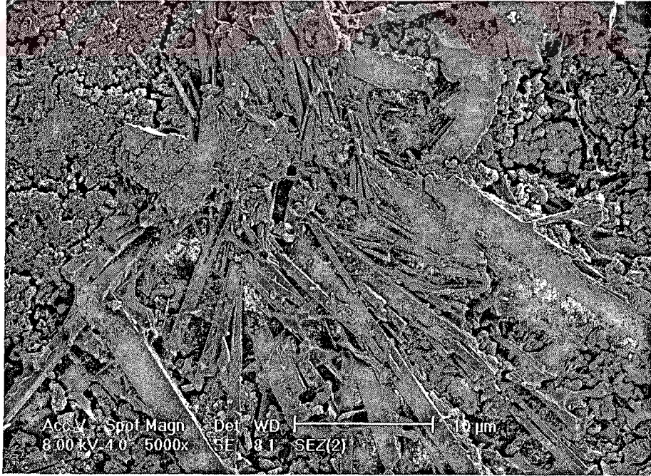
Şekil 4.13. SEZ kompozisyonuna sahip numunelerinin 1350°C'de çift pişirilmesi ile mikroyapıda gelişen müllit ve anortit kristalleri.
