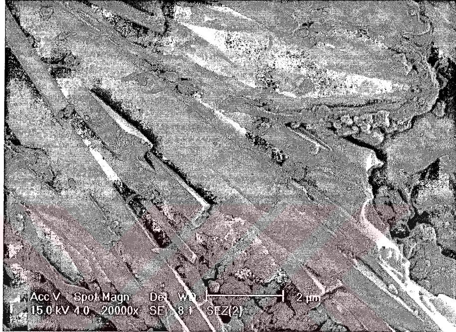
Şekil 4.14. SEZ kompozisyonunda gelişen iğnemsî yapıdaki müllit kristallerinden 20000x büyütmede alınan SEM mikrografı.
