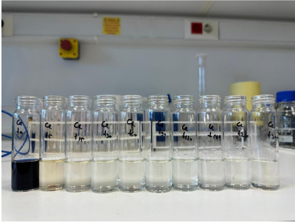
Şekil 9.15: 100 ppm RB5 çözeltisinin farklı sürelerde elektrooksidasyon işlemi sırasında alınan numunelerdeki renk değişimi.
