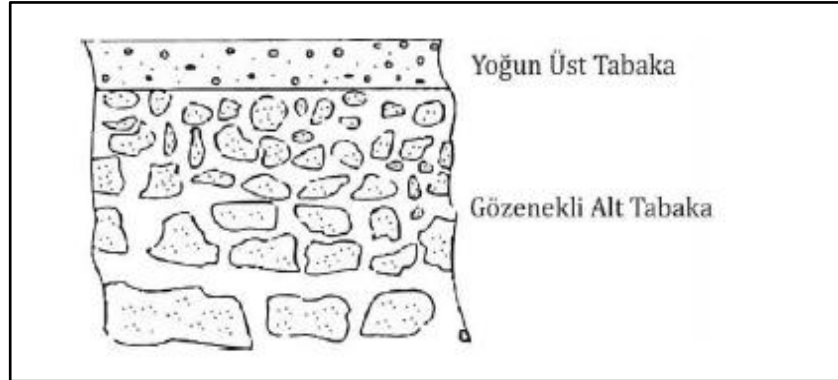
Şekil 2.4: Destek tabakası ve aktif tabakadan oluşan bir membran kesiti.
