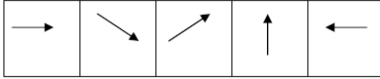
Şekil 5.1. Manyetik alan uygulanmayan rastgele yönelmiş ferromanyetik domainler.
