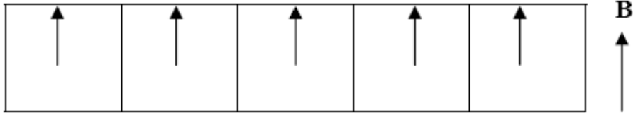
Şekil 5.2. Dış manyetik alandan dolayı yönelmiş ferromanyetik domainler
