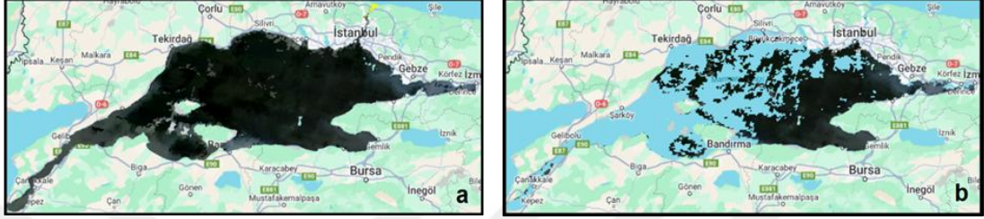
Şekil 4.4: Kalite ve bulut filtreleme öncesi (a) ve sonrası (b).
