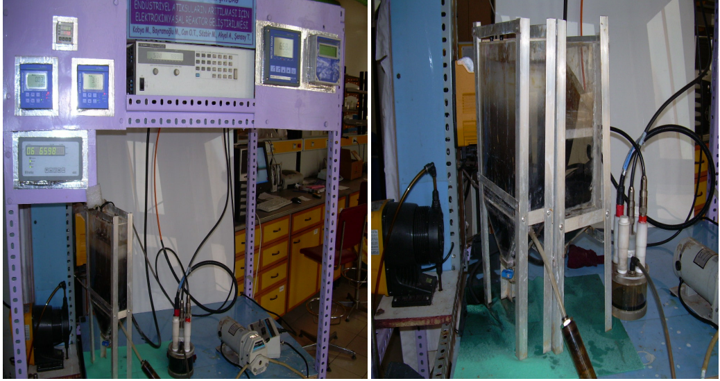
(a) EC optimizasyonunda kullanılan EC prosesinin görünüşü
