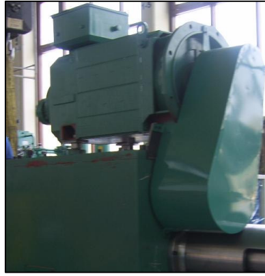
Şekil 3.6. Bir Sıvama Makinesinde, 180kW 'lık Asenkron Servo-Motor Uygulaması.
