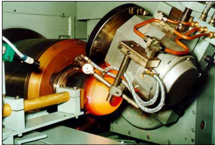
Şekil 4.33. Boğaz Sıvama İşlemine Ait Bir Görünüm.
