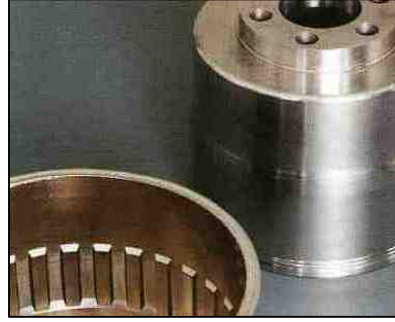
Şekil 4.29. Bağımsız-Et Kalınlığı Değişimli Sıvama Esnasında İç Yüzeyine Diş Açılmış Örnek Bir Parça.
