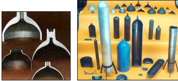
Şekil 4.35. Boğaz Sıvama İle İmal Edilmiş Örnek Parçalar.
