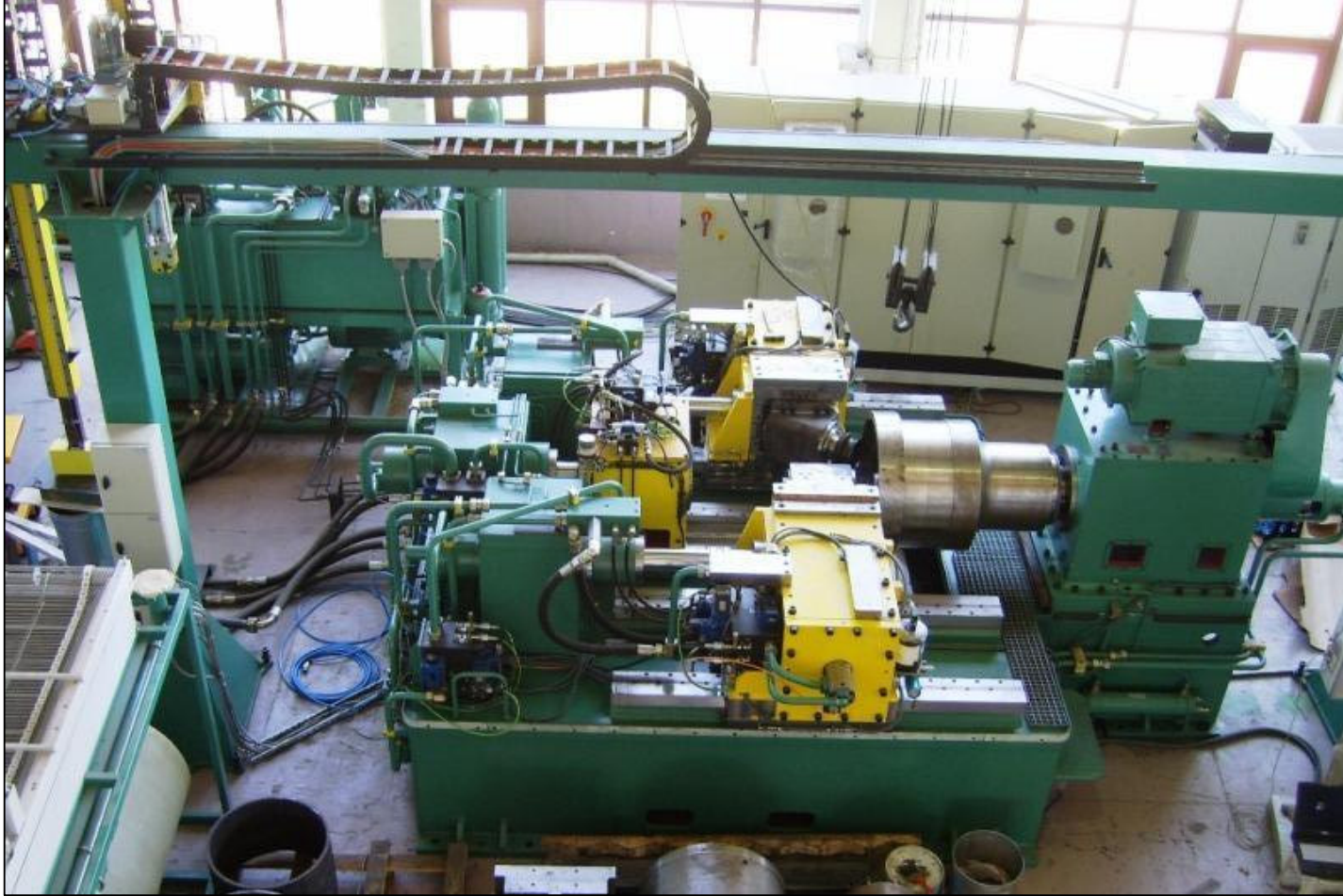
Şekil 5.26. Disk Sıvama Makinesinin Bir Üst Modeli Olan “Jant Makinesi”.
