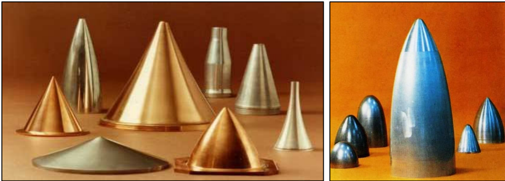
Şekil 4.15. Bağımlı-Et Kalınlığı Değişimli Sıvama İle Yapılmış Örnek Parçalar.
