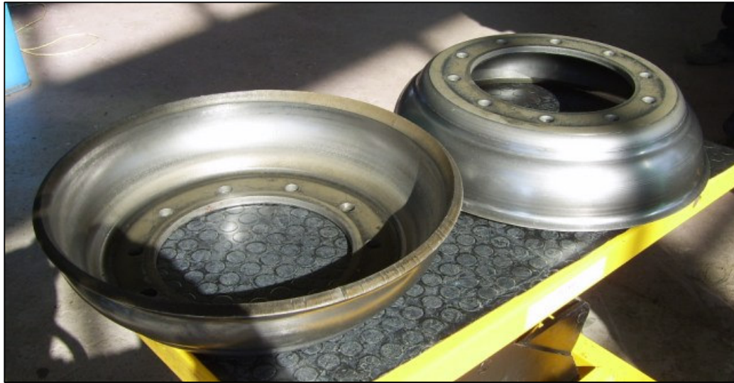
Şekil 5.25. Disk Sıvama Makinesi İle İmal Edilmiş Diskler.
