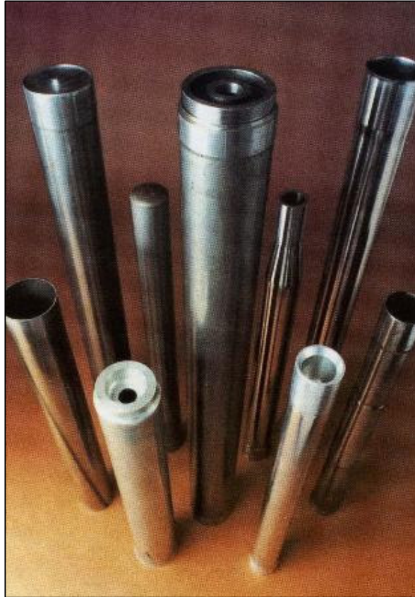
Şekil 4.27. Bağımsız-Et Kalınlığı Değişimli Sıvama İle Üretilmiş Boru Biçimli Gövdeler.
