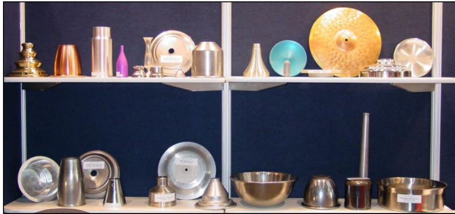
Şekil 4.9. Standart Sıvama İle Üretilmiş Örnek Parçalar.
