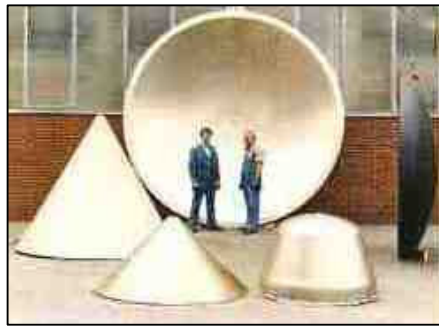
Şekil 4.10. Standart Sıvama İle Üretilmiş Büyük Çaplı Parçalar.
