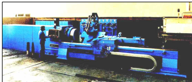
Şekil 4.36. Örnek Bir Boğaz Sıvama Makinesi.
