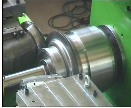
Şekil 4.2. Bağımlı-Et Kalınlığı Değişimli Sıvama İşlemine Ait Bir Görünüm.
