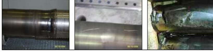
Şekil 4.30. Bağımsız-Et Kalınlığı Değişimli Sıvamada Karşılaşılan Bazı Sıvama Hataları.
