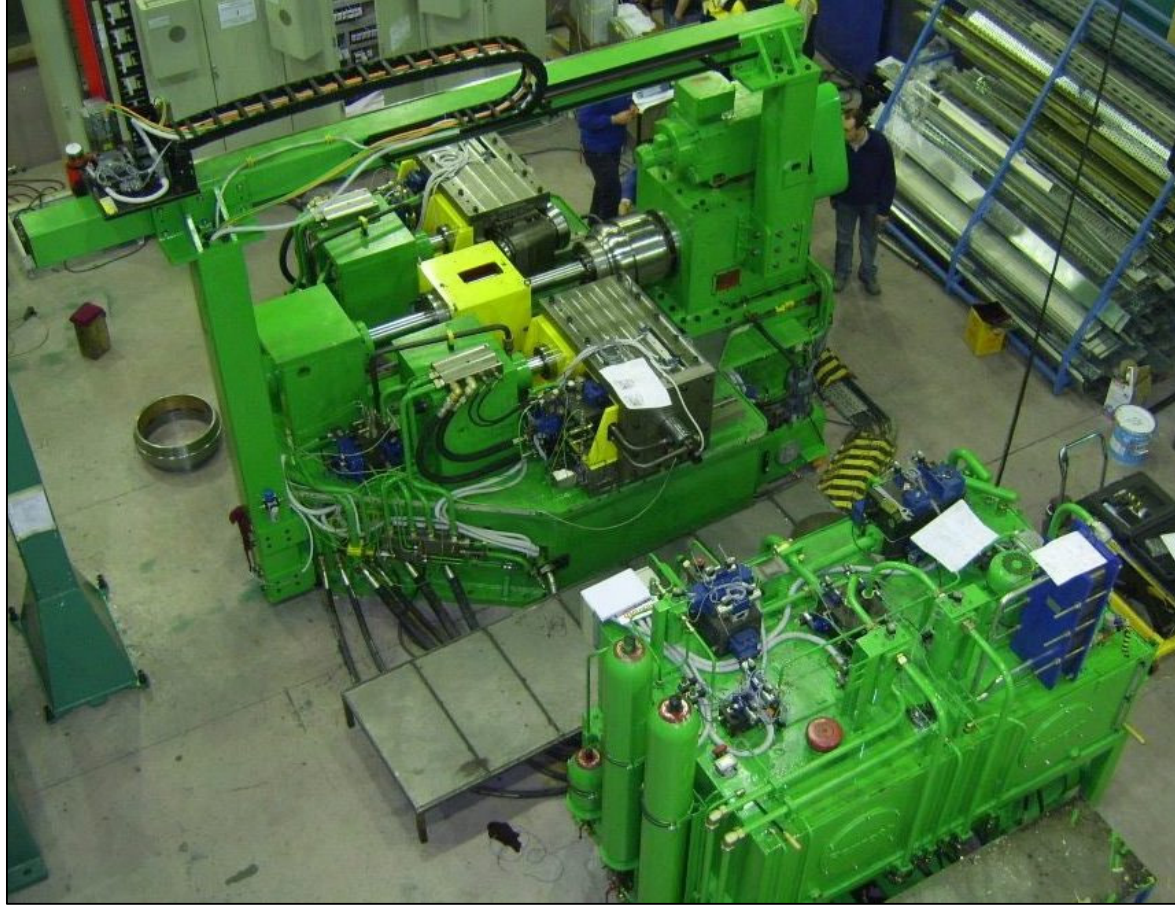
Şekil 5.23. Disk Sıvama Makinesinin Genel Montaj Aşamasından Bir Görünüm.
