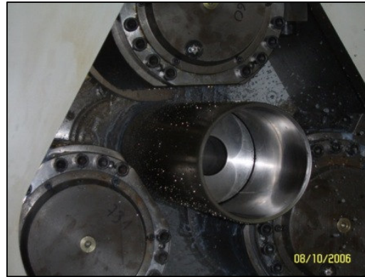
Şekil 4.26. Geriye Doğru Bağımsız-Et Kalınlığı Değişimli Sıvama İle İşlenmekte Olan Bir Parça.
