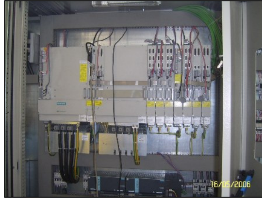
Şekil 3.8. Hidrolik Silindirlerle Çalışan Bir Sıvama Makinesine Ait CNC Kontrol Ünitesi ve H.L.A. Modülleri.
