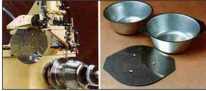
Şekil 4.16. Bağımlı-Et Kalınlığı Değişimli Sıvamada Dış Çapın Korunması.
