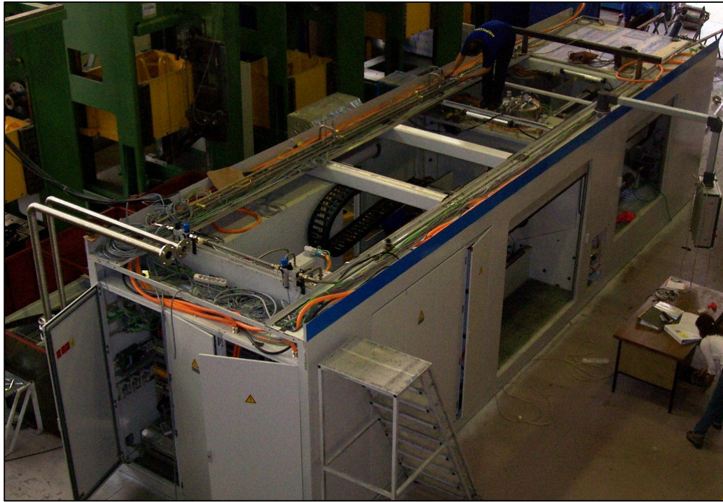
Şekil 3.10. Tamamen Hassas Vidalı Milller İle Kontrol Edilen İlk Sıvama Makinesinin İmalatına Ait Bir Görünüm.
