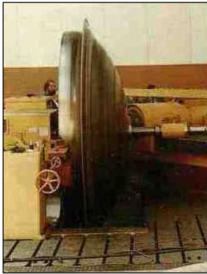
Şekil 4.17. Bağımlı-Et Kalınlığı Değişimli Sıvama (a) ve Standart Sıvamanın (b) Beraber Kullanımına Bir Örnek.
