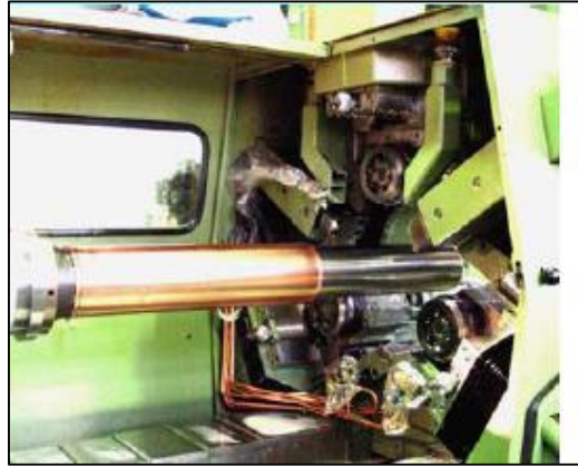
Şekil 4.3. Bağımsız-Et Kalınlığı Değişimli Sıvama İşlemine Ait Bir Görünüm.
