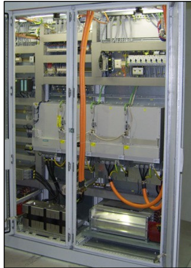
Şekil 3.9. Hassas Vidalı Millerle Çalışan Sıvama Makinesine Ait CNC Kontrol Ünitesi.
