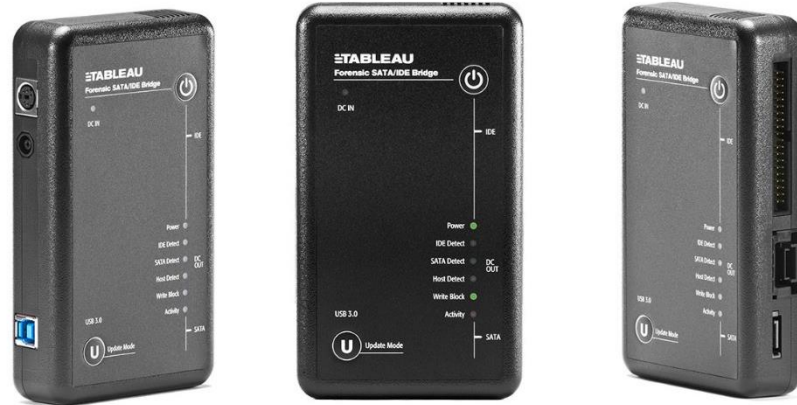
Şekil 3.3.1.1.1: Tableau T35u Yazma Koruma Köprü Kiti
