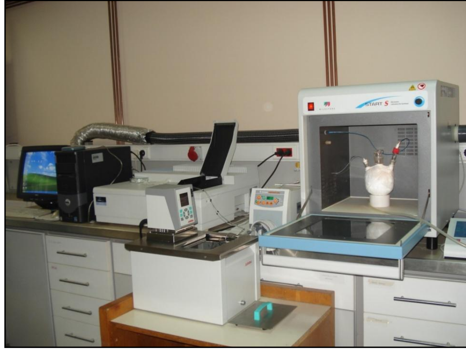
Şekil 9.2. On-line MW deney düzeneğinin fotoğrafı.
