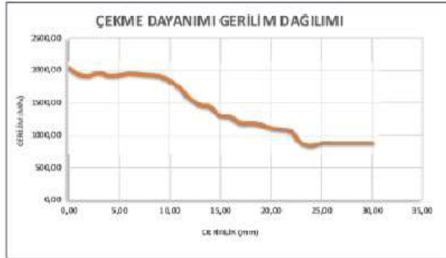
Şekil 6.2: Aks milinin sertlik tarama sonuçları.
