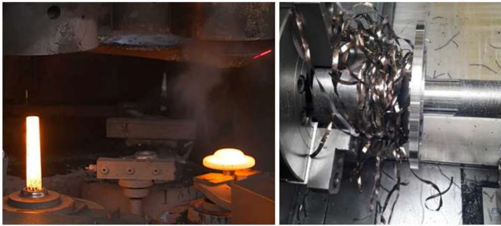
Şekil 5.8: Aks mili dövme ve işleme proses görseli.
