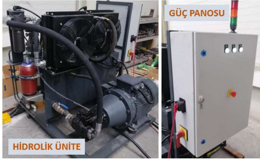
Şekil 7.3: Test sisteminin hidrolik ünite ve güç panosu.
