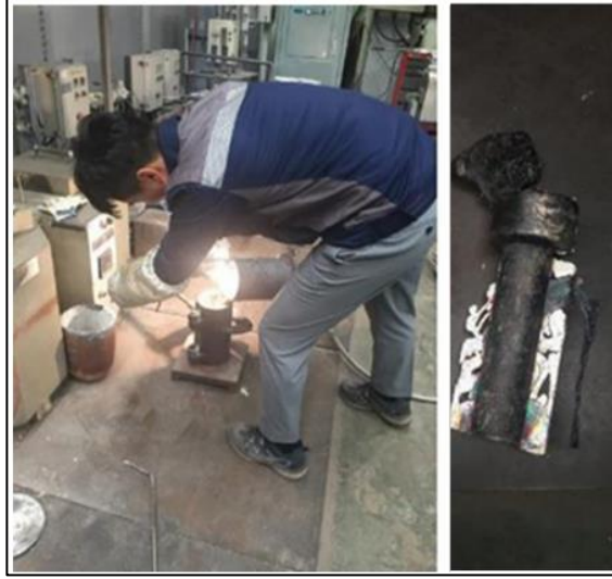
Şekil 6.1: Döküm yöntemi ve silindir numune.
