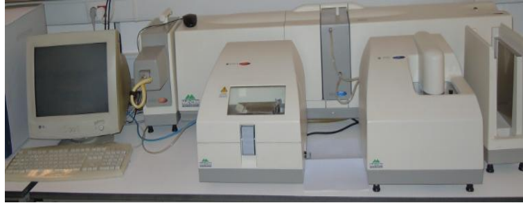
Şekil 3.1: Malvern marka tane boyut dağılımı cihazı.
