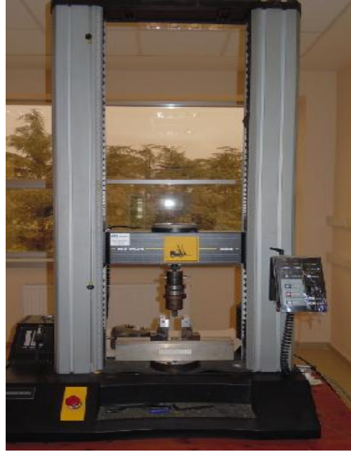
Şekil 3.6: Instron 5569 marka 3 nokta eğme deney düzeneği resmi.
