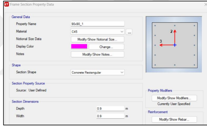
Şekil 3.13: Zemin kat dış aks kolon kesiti ve özellikleri.
