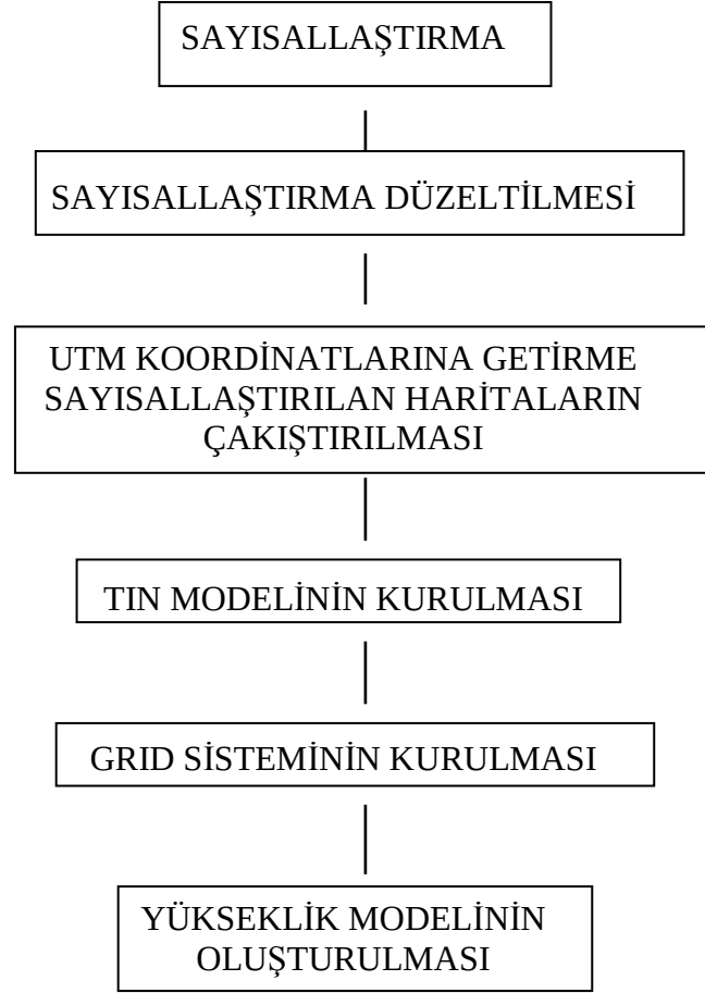
Şekil 21 : Sayısal yükseklik modelinin oluşturulması için akış diagramı
