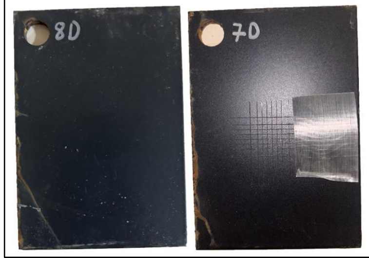
Şekil 4.5: 400 saat ISO 9227 - demir fosfat dönüşüm kaplamalı numune.
