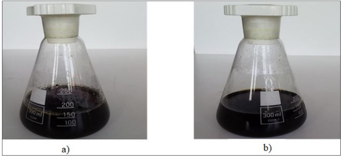
Şekil 4.3: a) Karanfil ekstraktı ile nanopartikül sentezi öncesi b) nanopartikül sentezi sonrası renk değişimi.
