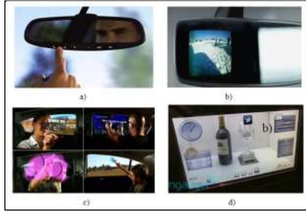
Şekil 2.2: Bazı akıllı pencere uygulamaları. a) otomotivde, b) dikiz aynalarında, c) otomobil pencerelerinde, d) cam yüzeylerdeki elektrokromik aygıt uygulamaları.
