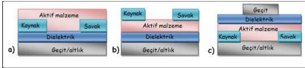
Şekil 2.15: Organik alan etkili transistörün değişik geometrik yapıları. a) alt kontak-alt geçit, b) alt geçit-üst kontak, c) üst geçit-alt kontak.
