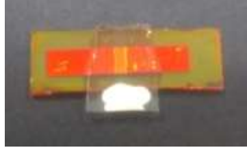
Şekil 4.22: ITO geçit elektrotlu, PMMA jel dielektrikli organik alan etkili transistör.
