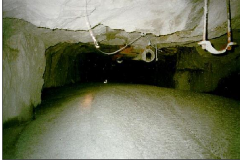
Şekil 2.7: Maden Atık Çamurların Yeraltı Ocaklarında Depolanması.
