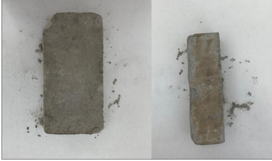
Şekil 4.8: Numune 2 Preslenmiş Örneğin Üstten ve Yandan Görünümü (20x10x4,5cm).
