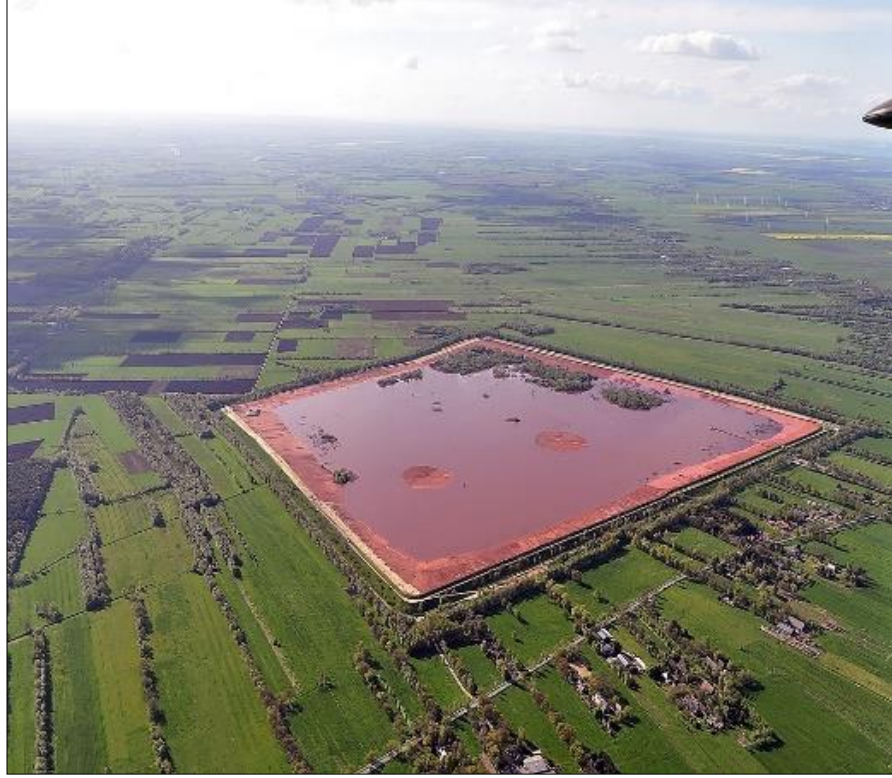
Şekil 2.6: Set Tipi Atık Barajı Örneği (Brezilya).
