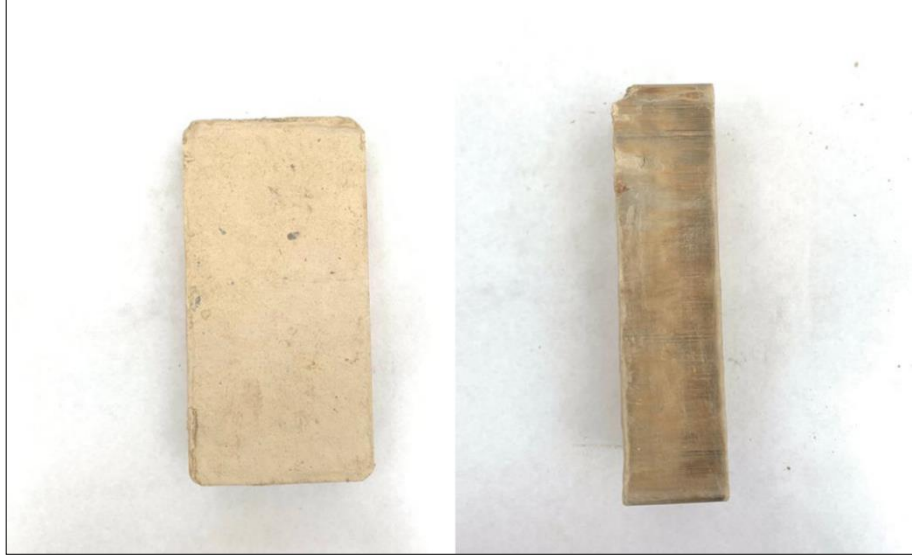
Şekil 4.12: Numune 4 Preslenmiş Örneğin Üstten ve Yandan Görünümü (20x10x4,5cm).
