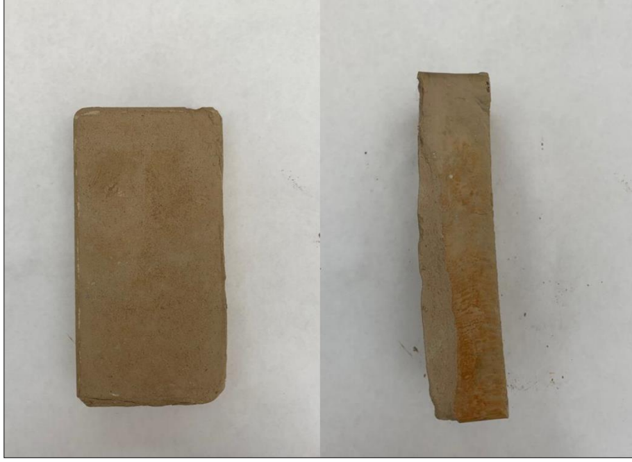
Şekil 4.10: Numune 3 Preslenmiş Örneğin Üstten ve Yandan Görünümü (20x10x4,5cm).
