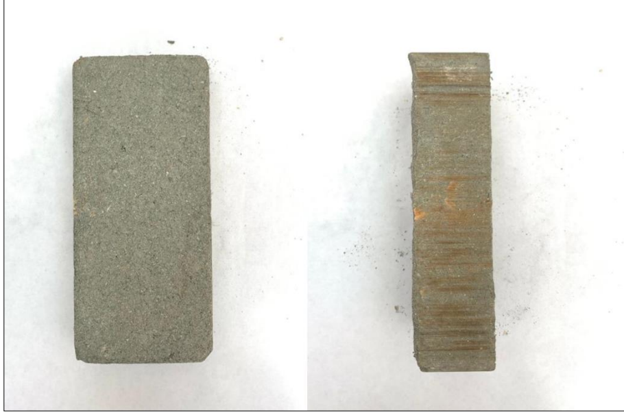
Şekil 4.6: Numune 1, 22MPa'da Preslenmiş Örneğin Üstten ve Yandan Görünümü (20x10x4,5 cm).
