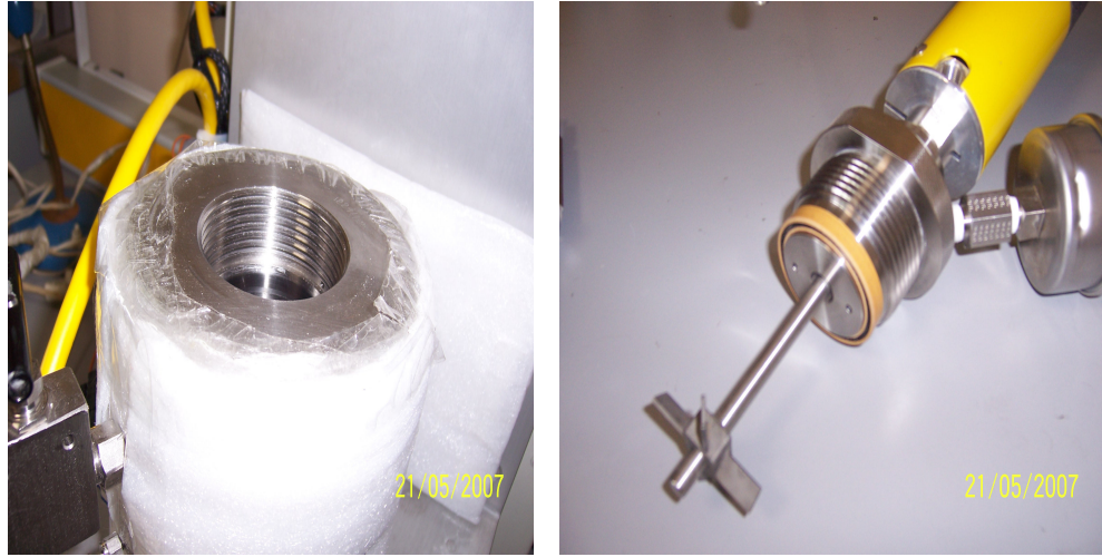
Şekil 6.5. Yüksek basınca dayanıklı reaktörün açık hali ve karıştırıcı görüntüsü
