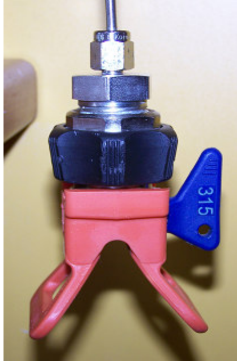
Şekil 6.13 Püskürtmenin yapıldığı kelebek ve kelebeğe takılı meme(nozzle) ucu
