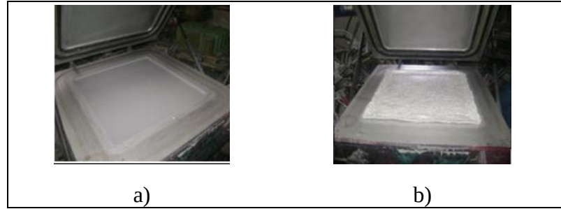
Şekil 3.6: a) Kürlenmiş jelkotlu yüzey görünümü, b) Jelkotlu yüzeye elyaf serilmesi.
