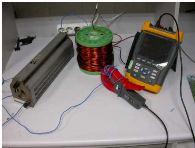
Şekil 3.30. Deney devresine seri bağlı X(bobin) ve R (direnç)
