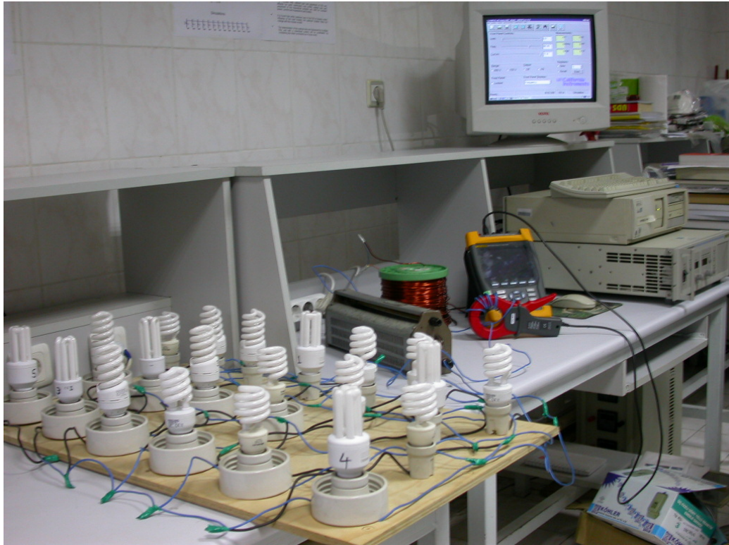
Şekil 3.3. Kompakt flüoresan lamba deney bağlantısı
