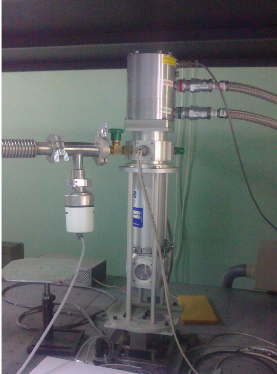
Şekil 5.2: Janis kapalı devre helyum kreostatu
