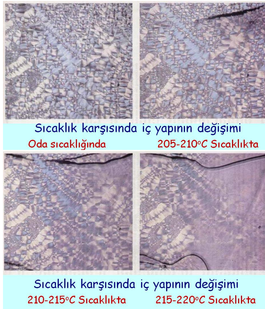
Şekil 2.5 Yarı kristalin termoplastiklerin sıcaklığa bağlı olarak iç yapı değişikliği [Tanrıkulu, 2005].
