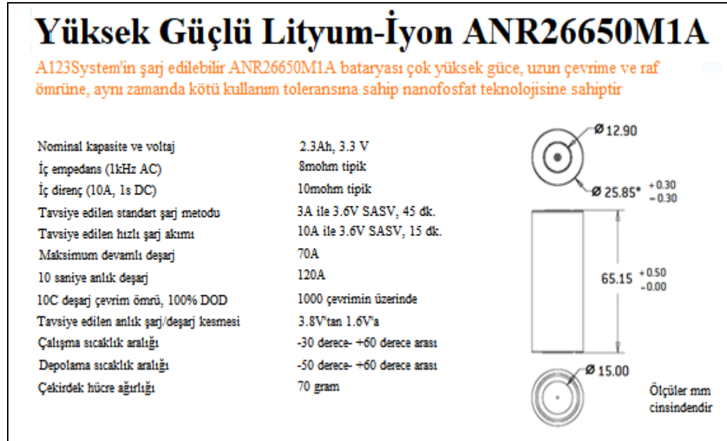
Şekil 3.1: ANR26650M1A silindirik hücre özellikleri.
