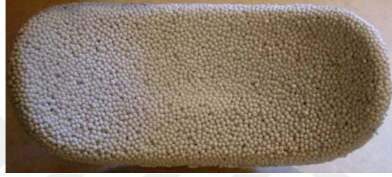
Şekil 3.6: Boncukların yapıştırılmasıyla üretilmiş olan genleştirilmiş polipropilen parça (Sopher, 2003).
