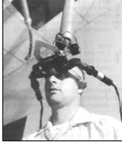
Şekil 3.3: HMD (Head Mounted Display/Başa Monte Ekran), Ivan Sutherland, 1968.
