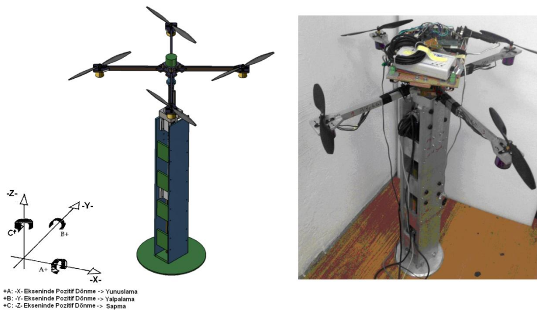
Şekil 4.1 Uçuş aracı test düzenegi
