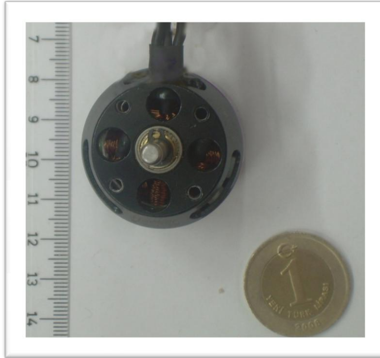
Şekil 4.4 Uçuş aracı test düzeneğinde pervaneleri çeviren motorlardan biri
