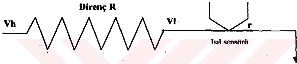
Şekil 2.8. Yüksek Gerilimler İçin Direnç ve Isıl Çevirici Kombinasyonu
