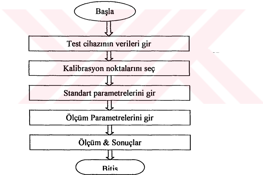
Şekil 3.6.AC-DC Transfer Yazılımı Genel Akış Diyagramı
