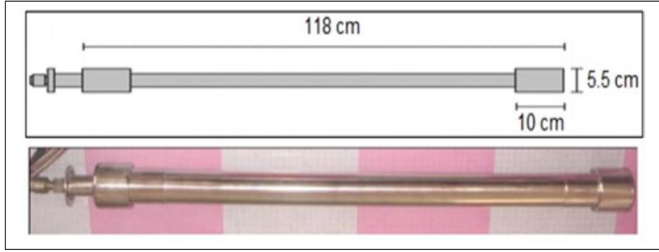
Şekil 4.2: Radyal etkili ultrases probu fotoğrafı ve şematik görünümü.
