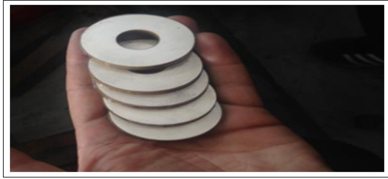
Şekil 3.4: Piezoelektrik özelliğine sahip seramik kristaller.
