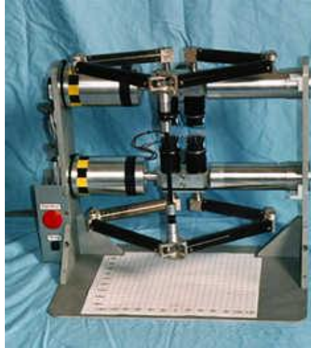
Şekil 3.1. Beş Serbestlik Dereceli Twin Pantograph Haptik Arayüz
