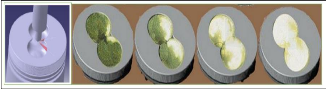
Şekil 3.9: Kendinden tutuşmalı çift döngülü MR-2 yanma odasının şeması ve fiziksel modelde yanma sürecinin anlık fotoğrafları.
