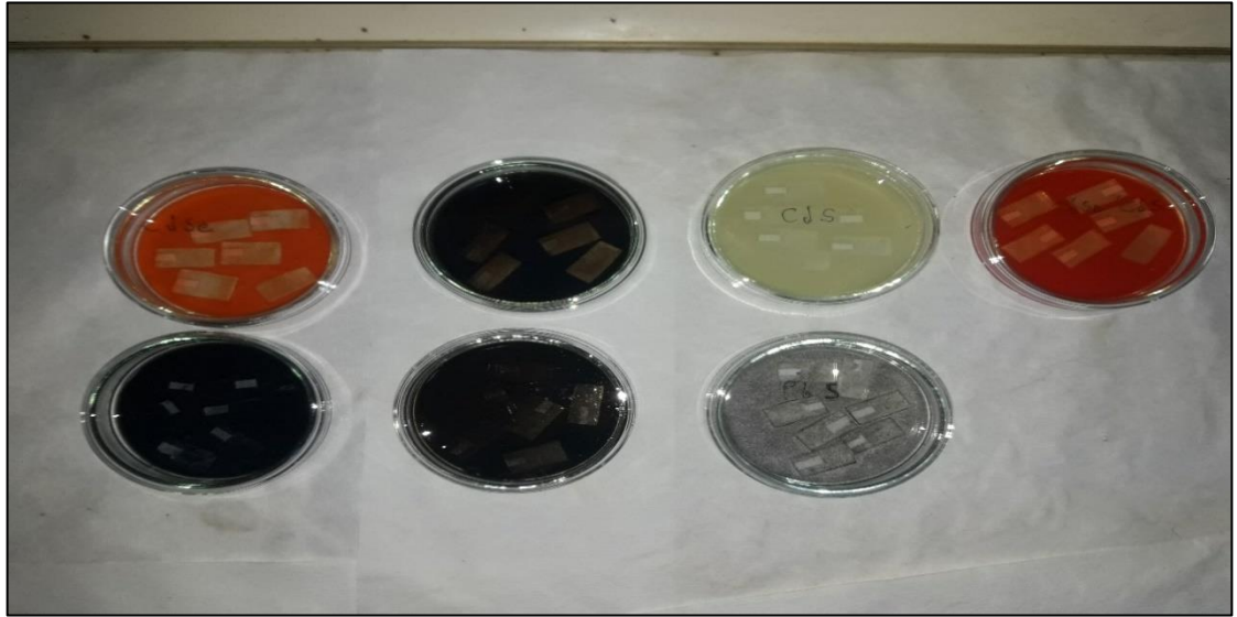
Şekil 3.3: Kimyasal banyo tekniği ile QD'lerin \text{TiO}_2 macun içerisine depolanması.
