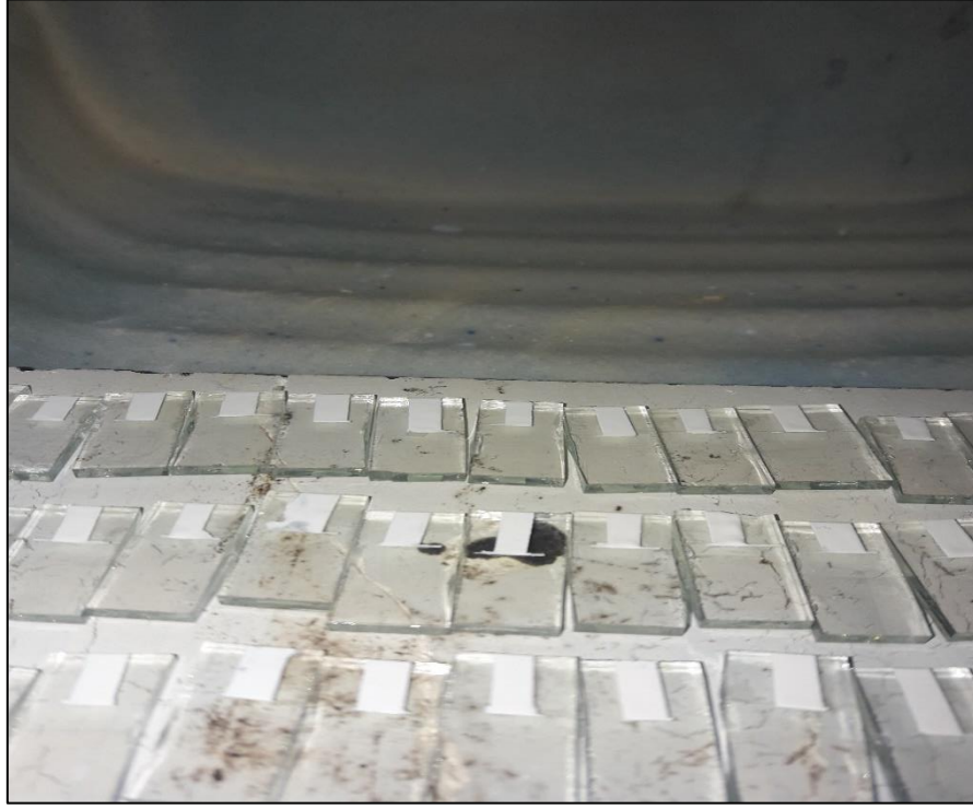
Şekil 3.1: Doktor Blade tekniği ile FTO kaplı cam üzerine hazırlanmış \text{TiO}_2 nano parçacıkların 500^\circ\text{C} 'de tavlama sonrası görüntüleri.
