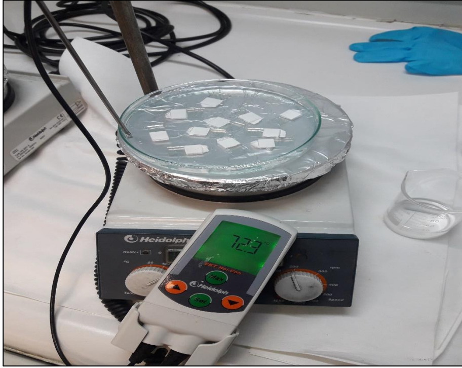
Şekil 3.2: TiO 2 kaplamaların TiCl 4 ile şoklama yapılması.
