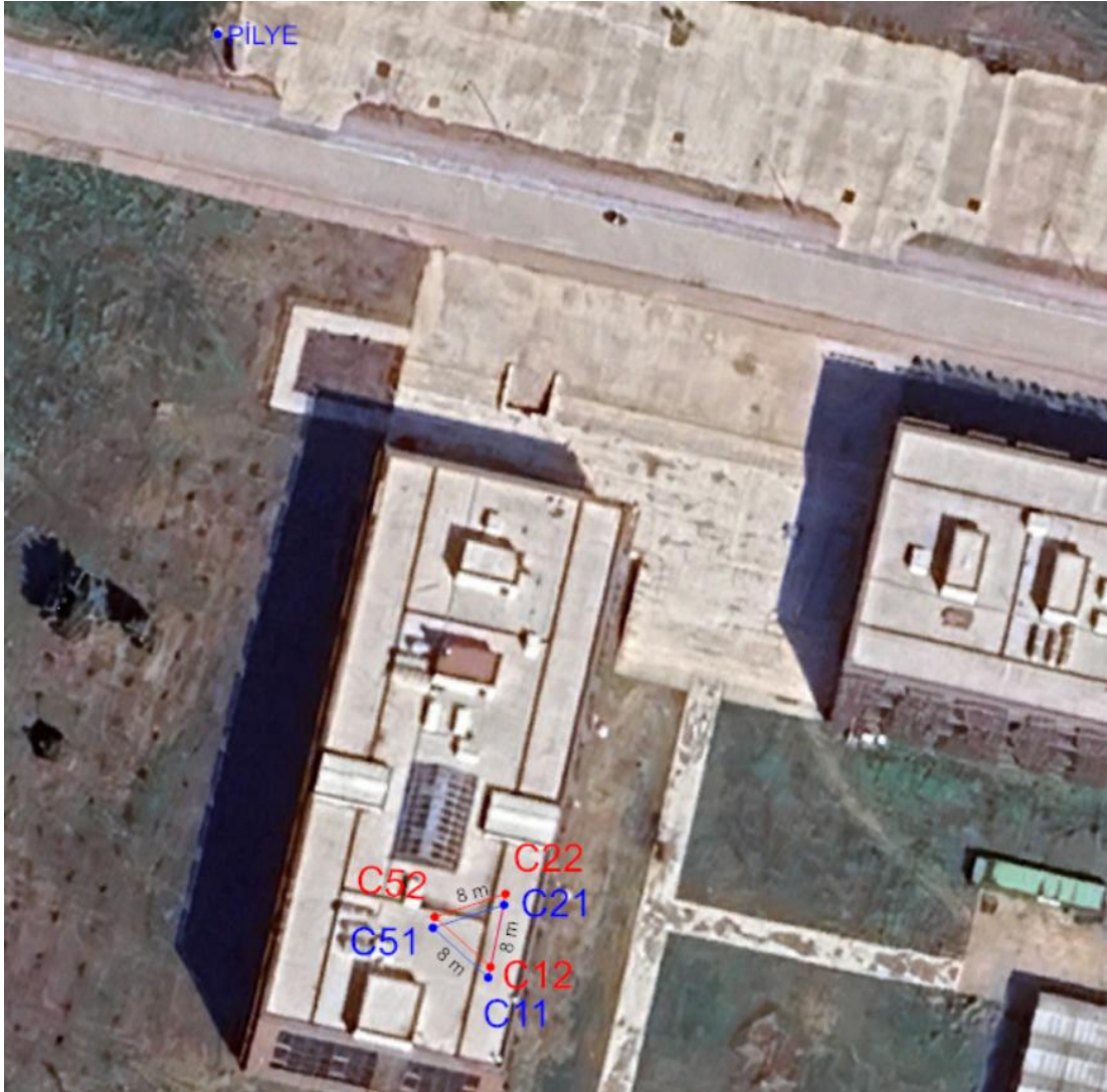
Şekil 7.2: GNSS ölçüm düzeneğine ait plan.
