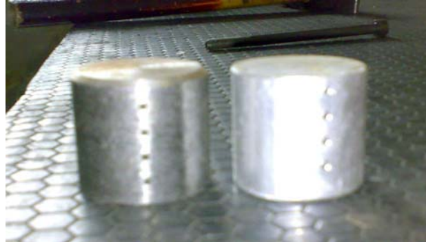
Şekil 4. 3., Al6063 ve Ç1040 malzemeleri
