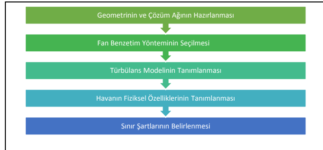
Şekil 3.10: HAD yöntemi işlem adımları.
