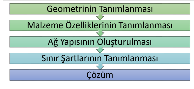
Şekil 2.1: Yapısal benzetim işlem basamakları.
