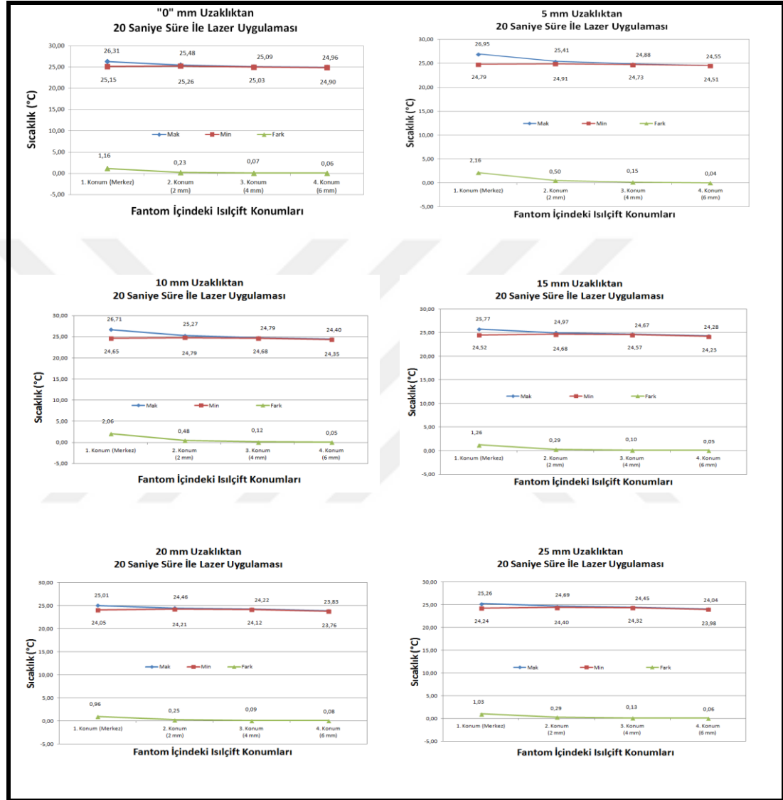
Şekil 4.72: 20 saniye boyunca Zerdine fantomu üzerinde 0 mm, 5 mm, 10 mm, 15 mm, 20 mm ve 25 mm mesafesinden 635 nm lazer uygulaması ile ısı çiftlerinden ölçülen maksimum sıcaklıklar, minimum sıcaklıklar ve sıcaklık farkları grafikleri.
