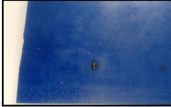
Şekil 4.122: Mavi renkli özel soğurucu malzemenin yakın mesafede kömürleşmesi.
