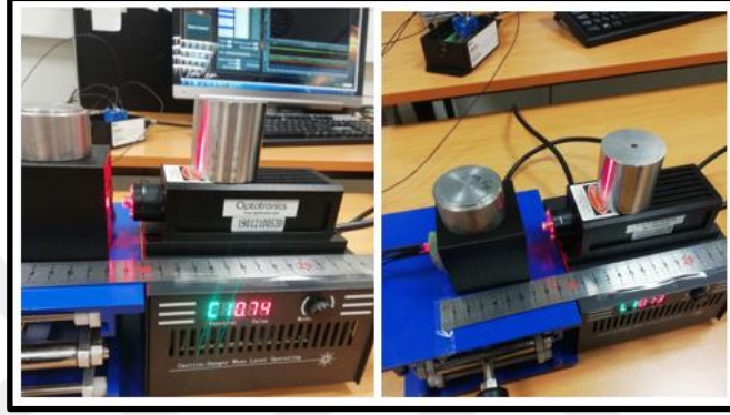
Şekil 4.92: Deney sırasında siyah kap içinde bulunan kas fantomu ve lazer aktif haldeyken kas fantomu içinden ısı çiftleri ile yapılan sıcaklık ölçümleri.
