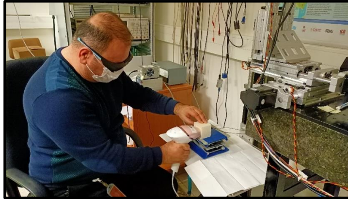
Şekil 4.127: IPL ile kas fantom ile yapılan bir sıcaklık ölçüm çalışması.
