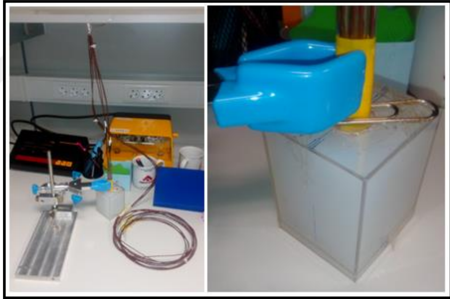
Şekil 4.136: İçinde ısıl çiftler bulunan agar fantomu.
