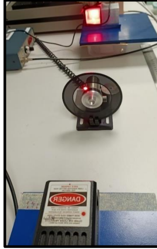
Şekil 4.148: Darbeli lazer ışığı ile test edilen malzemenin fotoakustik olarak tetiklenmesi sürecinin yanal olarak gösterimi.
