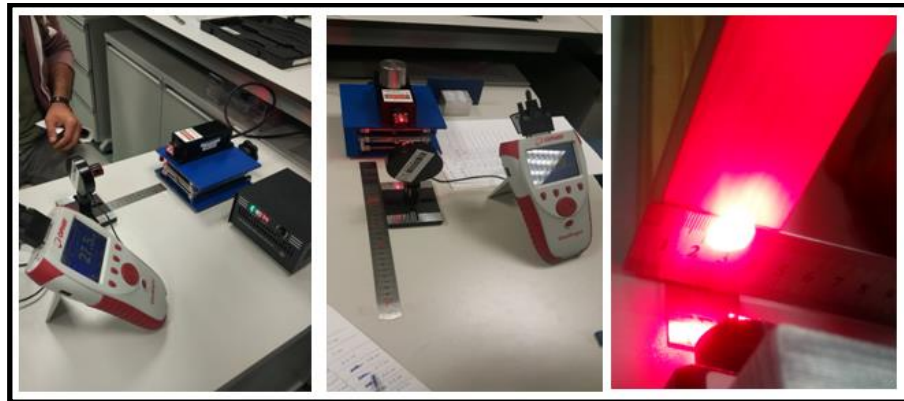
Şekil 4.124: Lazerin optik güç yoğunluğunun belirlenmesi.
