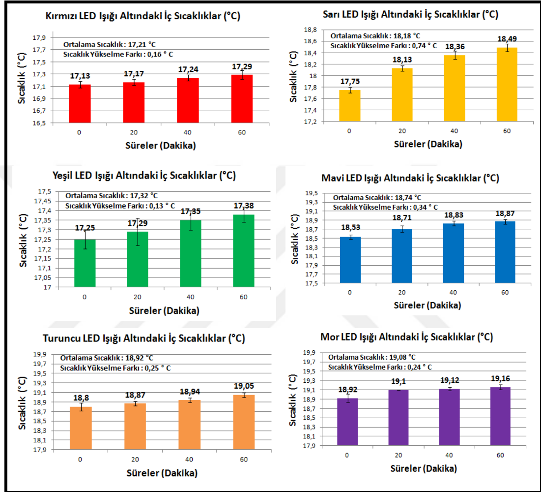
Şekil 4.141: Farklı LED ışıkları altında agar fantomu içinde yapılan iç sıcaklık ölçümleri.
