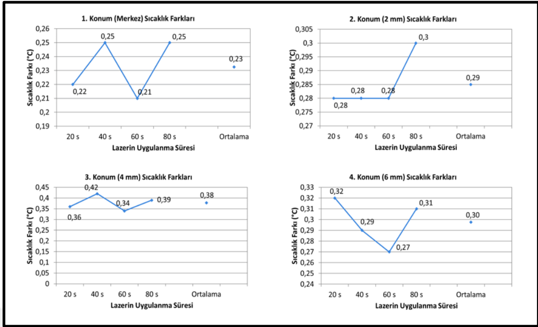
Şekil 4.105: Sıfır konumunda kas fantomu üzerinde ısı çiftler tarafından farklı sürelerde ölçülen sıcaklık farkları.
