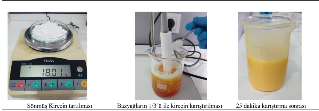
Şekil 3.4: Mineral yapılı baz yağ içinde sönmüş kirecin eritilmesi.
