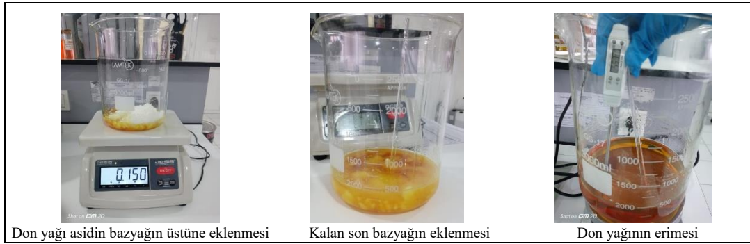
Şekil 3.5: 2. Beherde mineral baz yağına don yağı asidi ilave edilip, eritilmesi.
