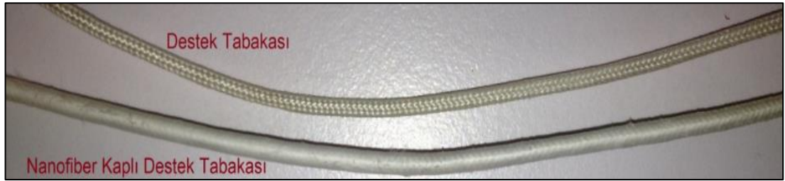
Şekil 3.7: Çalışma Kapsamında Nanofiber Kaplanmış Bir Tübüler Membran Görüntüsü.
