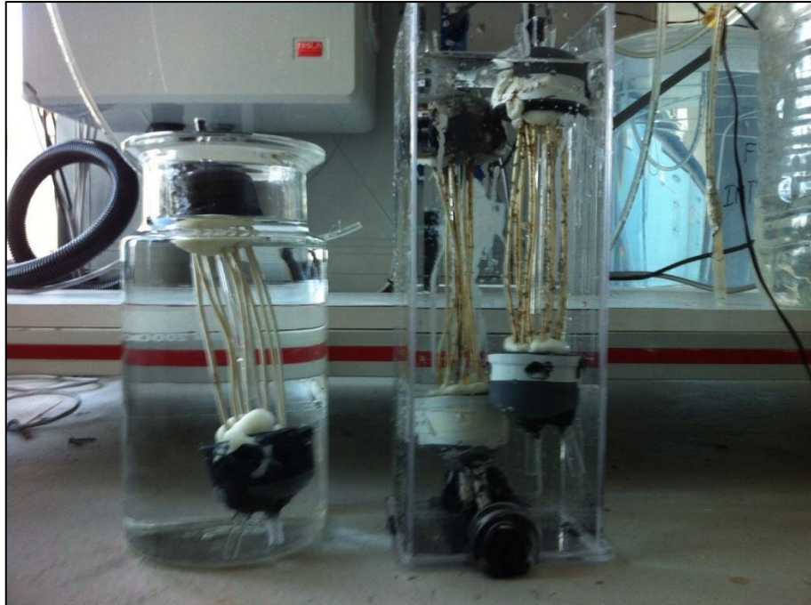
Şekil 3.15: Dâhili MBR Sisteminde Yer Alan Yeni ve Kullanılmış Modüller.
