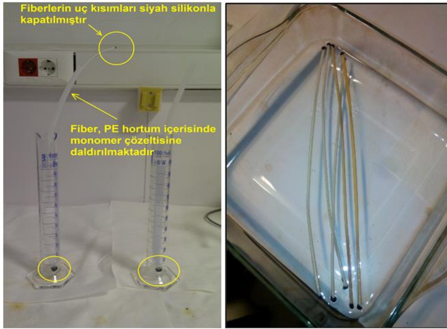
Şekil 4.8: Fiberlerin İnce Film Kaplama Denemeleri
